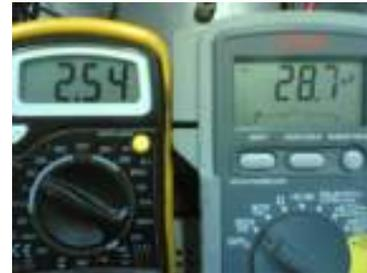
**Gambar 4.2** Pengukuran Tegangan Keluaran Loadcell
